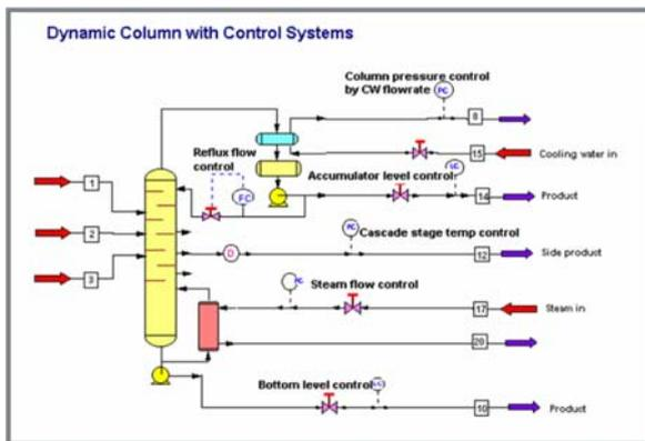
采用严格的板效率估算和质量传递计算的方法，探讨控制策略，维护流程安全，分析扰动影响
