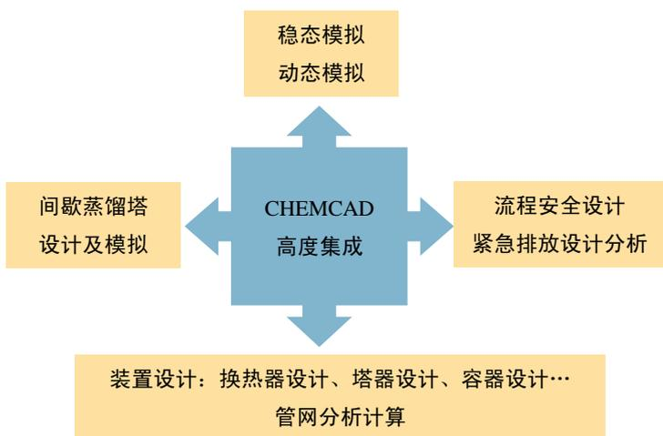
CHEMCAD 将稳态模拟、动态模拟、间歇操作、安全设计、管网分析等计算功能，与换热器设计、塔器设计、容器设计等多项装置的设计功能，完全集成于单一的软件接口，相互支持、灵活运用，使工艺设计、计算分析更精确完善，完全不存在数据传递或软件接口出错的问题，极大地提高了工程仿真的计算效率。
