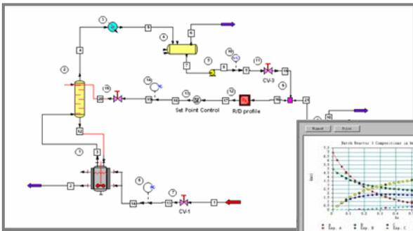
适用于探讨反应机理、设计反应器、优化单元操作、研究热效应、模拟反应器安全问题（失控问题）、进行 HAZOP 及生产操作培训
